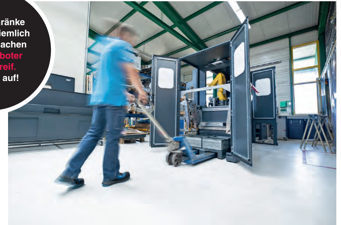
Mobile Box: Mit Rollen an den Schränken lassen sich die Zellen abwechselnd an mehreren Maschinen nutzen. Das System kann langsam wachsen.
